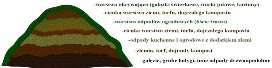
Rys. 1 Przykładowy przekrój przez warstwy pryzmy kompostowej
